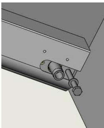
Una volta fissata la motorizzazione bisogna assolutamente che quest'ultima sia in bolla sia verticalmente che orizzontalmente (spessorare se necessario).
