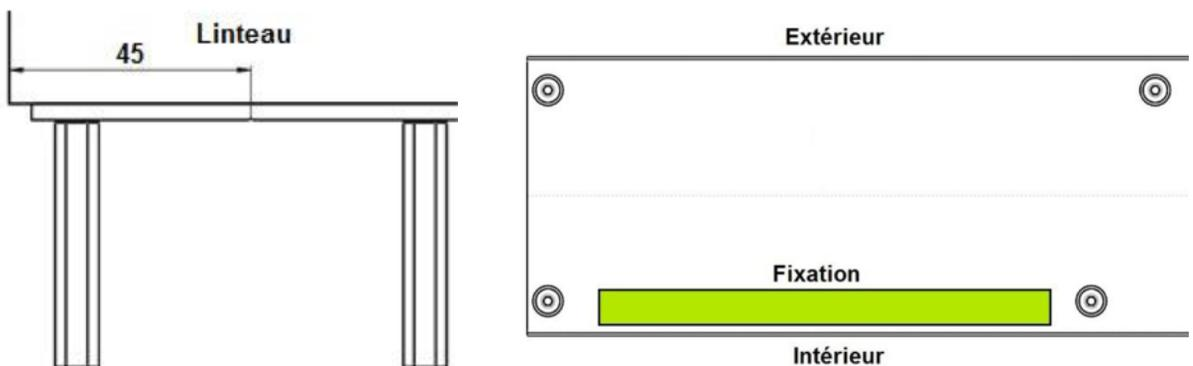
Fissare la piastra sottotrave. Consiglio : 1 vite ogni 300 mm + 1 vite (testa <10 mm) nella zona in verde (schema qui sopra)
