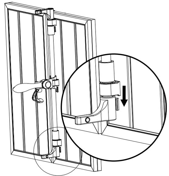
4. Fissaggio dei copri viti con cappuccio di protezione.
