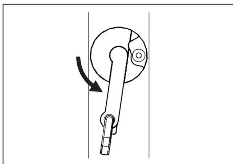
4. Posizionare il braccio sull'anta, rispettare l'orientamento delle dime e ruotare il braccio per accedere alle viti di fissaggio.
