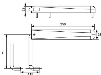
Per una tenuta ottimale far lavorare la leva a fine corsa.
