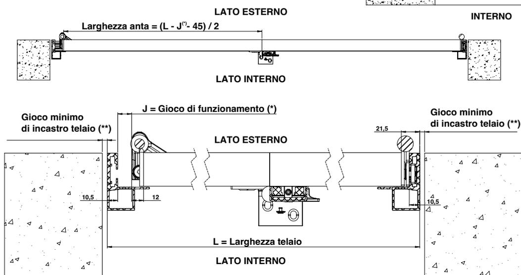
(\*) Il gioco di funzionamento J deve integrare l'arretramento del carrello durante la chiusura, le tolleranze dimensionali delle ante e del telaio nonché le dilatazioni legate alle variazioni igrometriche e termiche.
