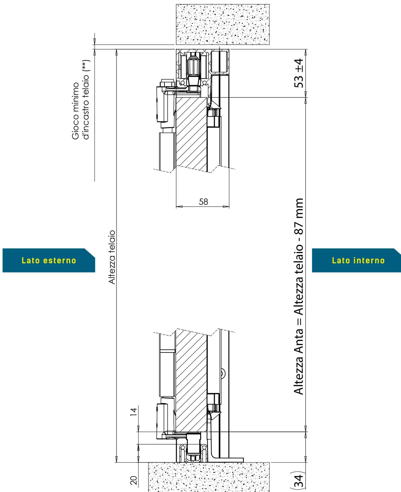
(\*\*) Sulle aperture di dimensioni minime suggeriamo un gioco minimo di incastro periferico del telaio di 5 mm
