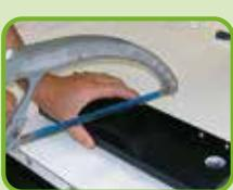
**Tagliare** il tubolare alla misura ottenuta sottraendo 5mm. Ad esempio : 200mm - 5mm = 195 mm
