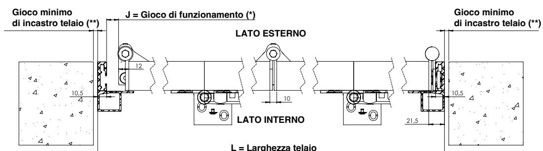
(\*) Il gioco di funzionamento J deve integrare l'arretramento del carrello durante la chiusura, le tolleranze dimensionali delle ante e del telaio nonché le dilatazioni legate alle variazioni igrometriche e termiche.
