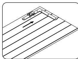
3.Infilare il nodo scelto nell'inserto di giunzione.
