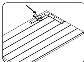
4.Posare l'imposta nell'alloggiamento e bloccarla verso l'alto con un giravite per fare leva.
