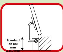
Per l'impiego di KOMODO® è necessario uno spazio minimo di 100 mm tra l'infisso esterno e quello interno.
