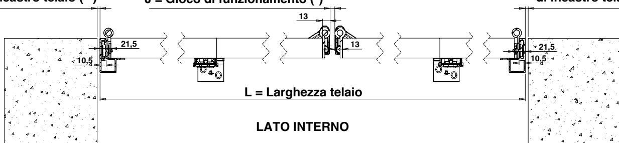
(\*) Il gioco di funzionamento  $J$  deve integrare l'arretramento del carrello durante la chiusura, le tolleranze dimensionali delle ante e del telaio nonché le dilatazioni legate alle variazioni igrometriche e termiche.
