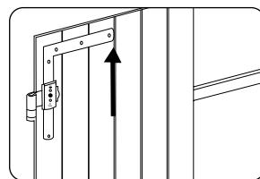
5.Far scorrere l'inserto di giunzione fino a far collimare il nodo con il cardine esistente a muro.
