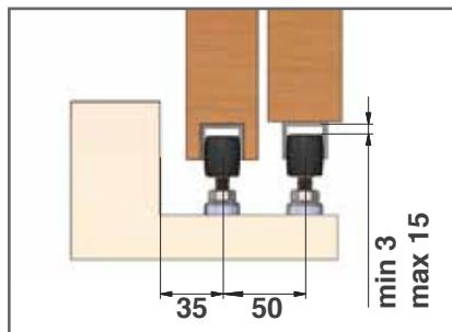
**Posizionamento delle olive a pavimento**
